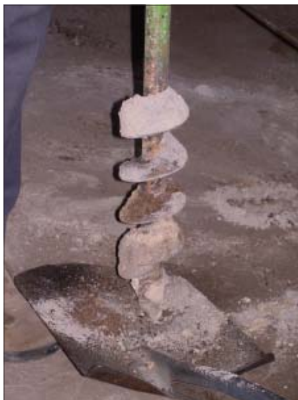
Figur 9. Jungfruhålet undersöks med hjälp av provborr. Foto: Kerstin Cassel.
